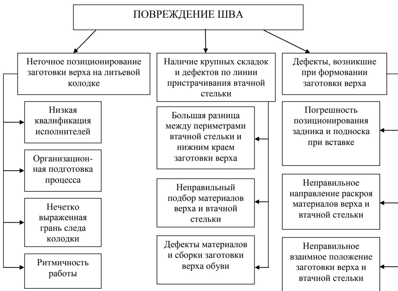
Рисунок 6.2 – Причины повреждения шва пристрачивания втачной стельки.
