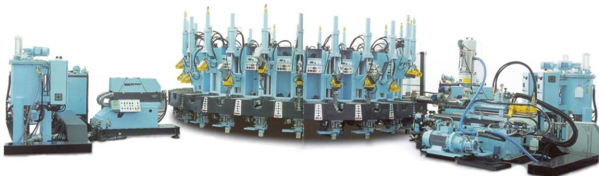
Рисунок 7.17 – Литьевой агрегат Pragma Combi - 24 фирмы Main Group для прямого литья двухслойного низа на обувь из ТПУ и ПУ.
