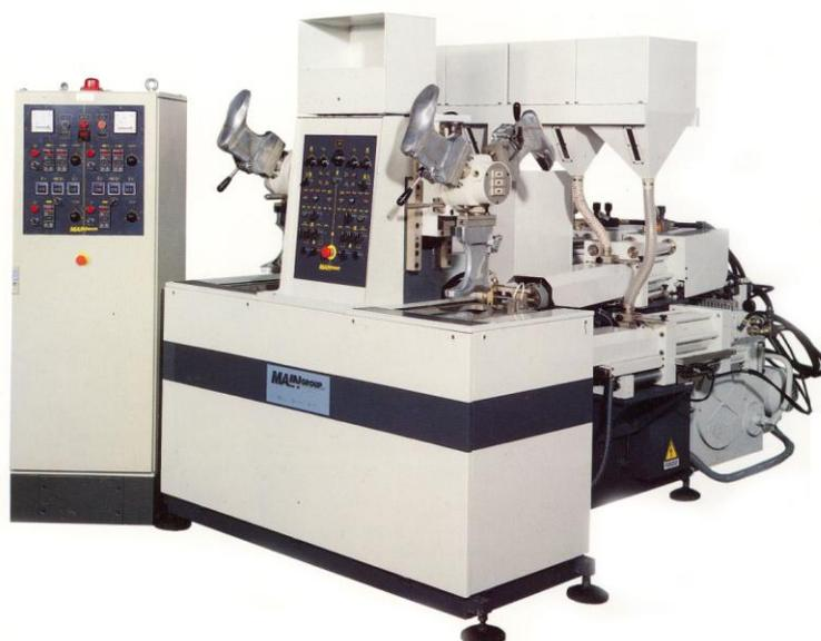
Рисунок 7.7 – Агрегат ТМ 477-2 статического типа фирмы Main Group для формования двухслойного низа на обуви
