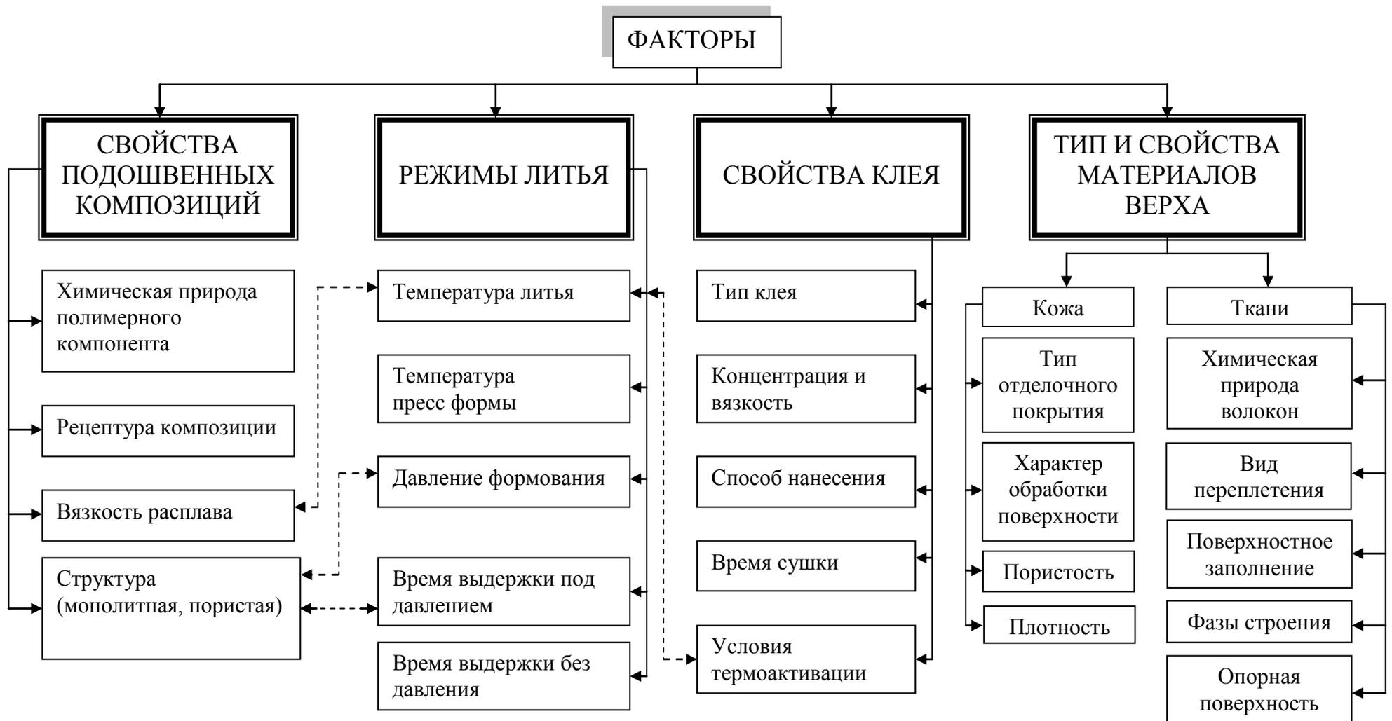
Рисунок 1.2 – Факторы прочности литевых соединений обувных материалов
